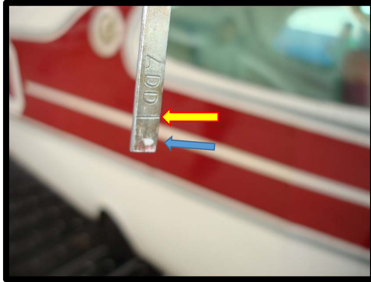
Fotografía No. 9 Nivel hidráulico bajo
